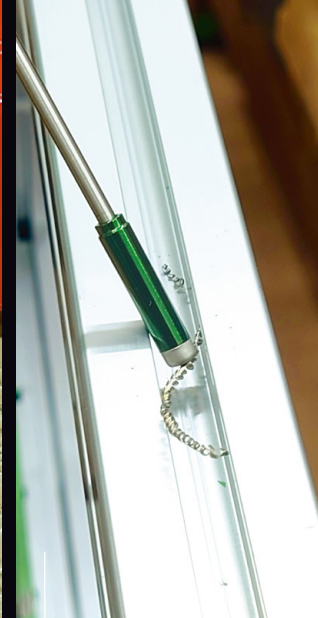
機械の隙間に 落ちた鉄屑
