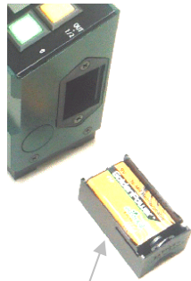
電池を取り出した状態
