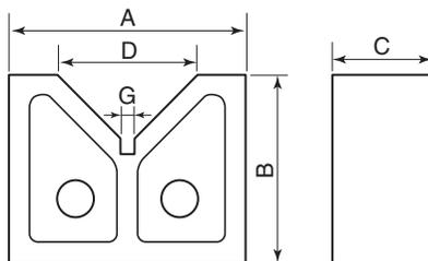
●底面とV溝の平行度・一对のVブロックのV面高さの相互差 … 0.05mm
